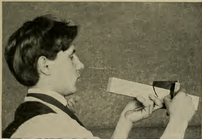
Fig. 41—Testing First Edge
